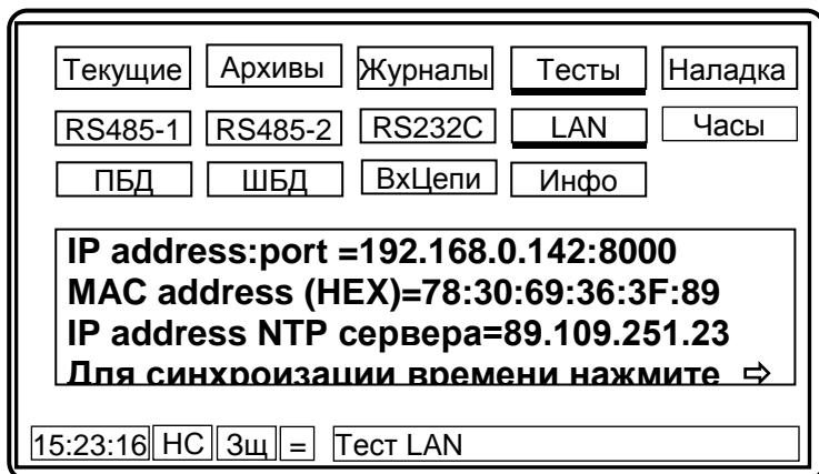
Рисунок 5.12 – Пример вывода на дисплей теста LAN
