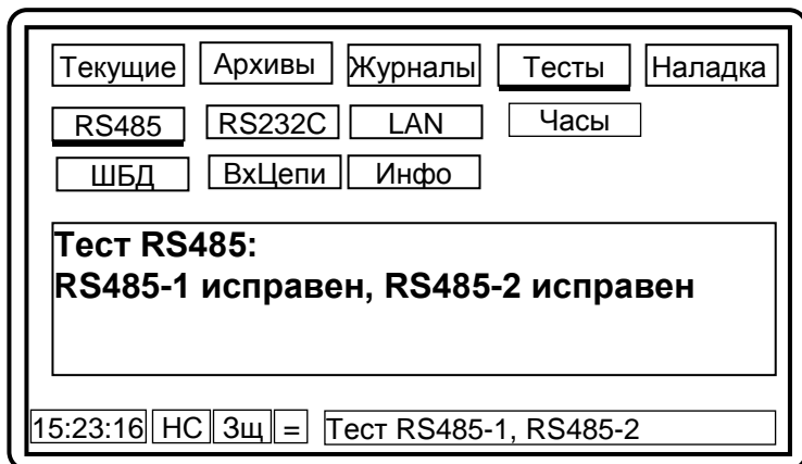
Рисунок 5.11 – Вывод на дисплей результата тестирования RS485
